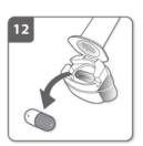
Abra o bocal novamente e remova a cápsula vazia, inclinando-a para fora do compartimento de cápsula. Jogue a cápsula vazia em seu lixo doméstico.
